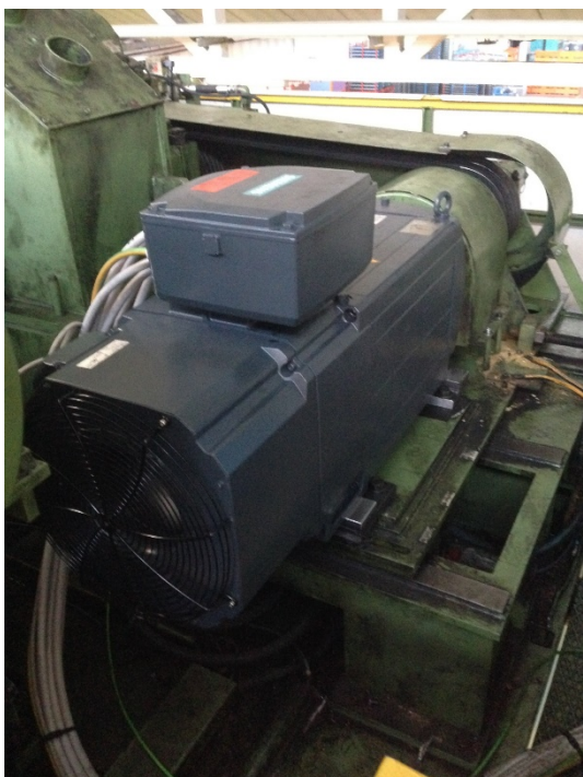
IMMAGINE 3 – Nuovo motore installato sulla pressa.
